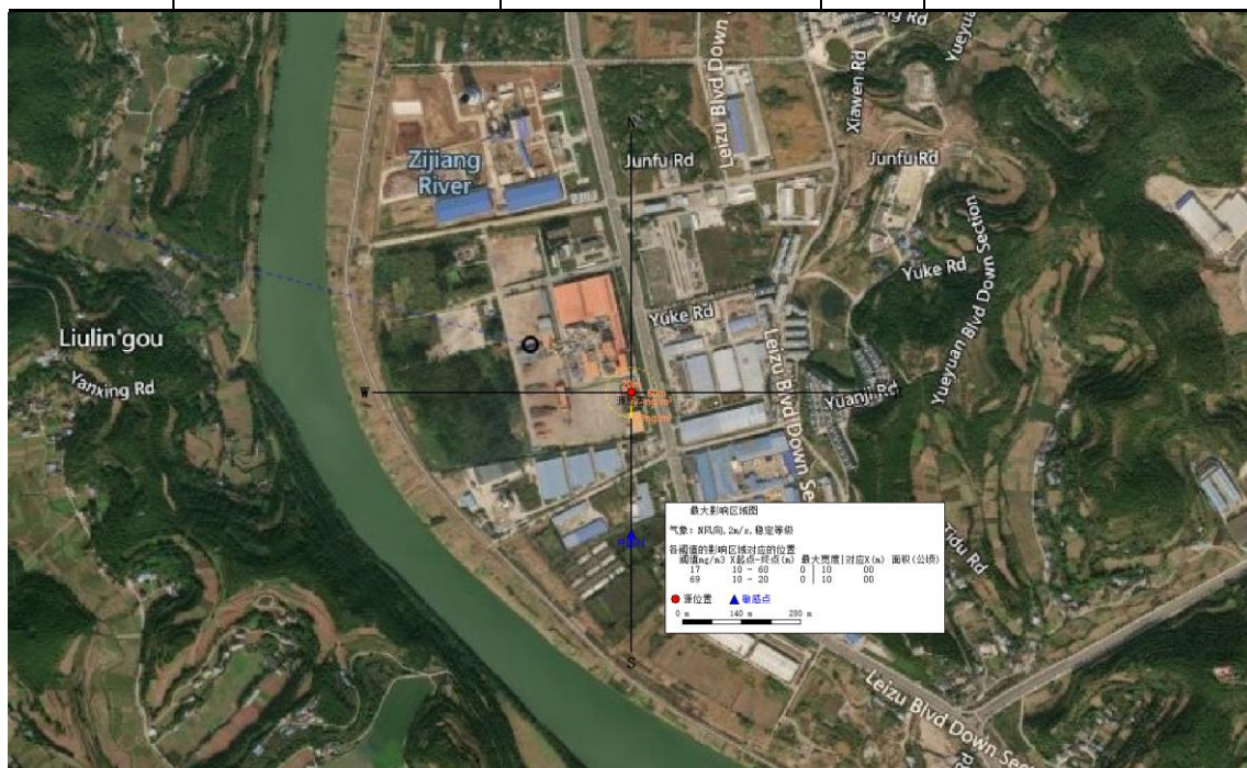
图 6.7-1 甲醛储罐泄露事故甲醛预测浓度达到关注限值最大影响范围图（最不利气象）
